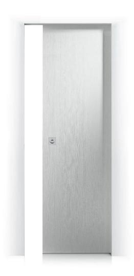
La porte coulissante à galandage invisible permet une ouverture totale dans un caisson (contre châssis) non fourni et monté au préalable pendant la construction des cloisons. Il n'y a pas de kit de finition car le caisson est conçu pour être enduit.
